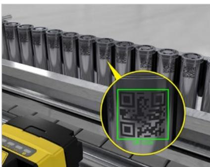
**DPM-Lesen:** Scannen von DPM-Codes auf der gekrümmten Oberfläche von zylindrischen Batterien
