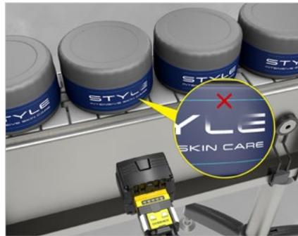
**Fehlererkennung:** Etiketten auf Endproduktverpackung prüfen
