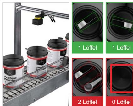
**Überprüfung der Montage:** Anwesenheit und Menge der Portionslöffel überprüfen
